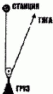
Графическая схема полиспаста с двумя подвижными блоками (отношение массы груза к тяговому усилию равно 4)
