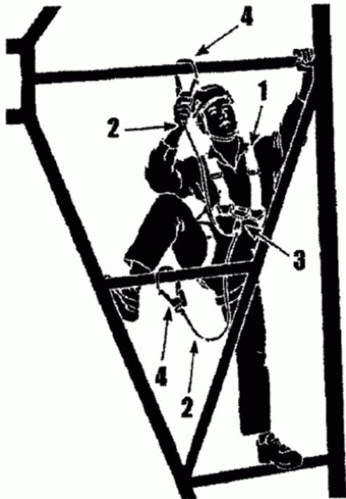
(карабин), который позволяет работнику присоединять страховочную систему для того, чтобы соединить себя прямо или косвенно с опорой. Конструкция карабина должна исключать случайное открытие, а также исключать защемление и травмирование рук при работе с ним.
