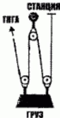
Графическая схема полиспаста с одним фиксированным и двумя подвижными блоками (отношение массы груза к тяговому усилию равно 6)
