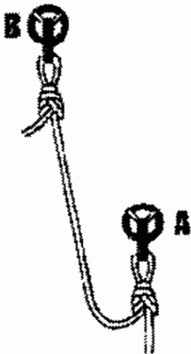
Вертикальное дублирование анкерных точек в анкерном устройстве. Угол между точками А и В должен быть не более  $30^\circ$ .
