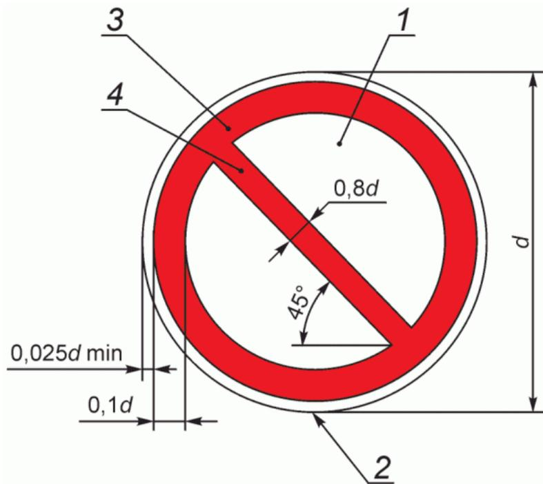
$d$  - диаметр круга; 1 - основная поверхность; 2 - кант;
