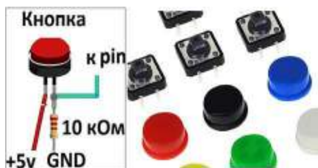
Рис. 1. Схема подключения тактовой кнопки к микроконтроллерной плате
