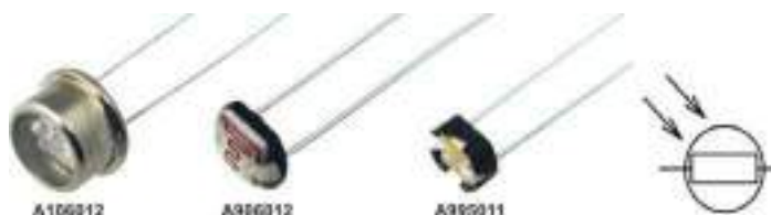
Рис. 12. Фоторезисторы и их обозначение
