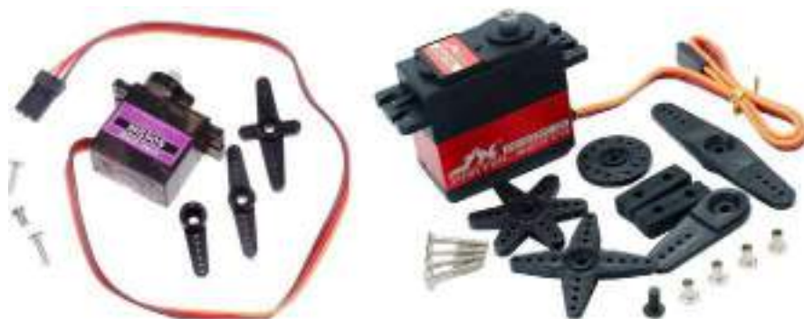
Рис. 19. Серводвигатели MG90S и PDI-6221MG-180
