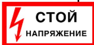
**2. Для предупреждения об опасности подъема по конструкциям, при котором возможно приближение к токоведущим частям, находящимся под напряжением**
