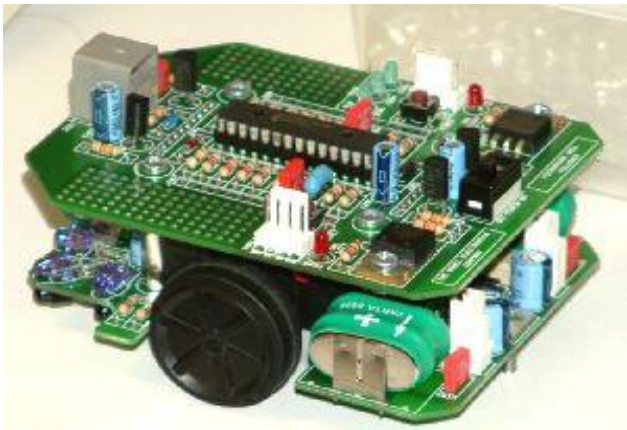
Робот для прохождения лабиринта на базе ATmega8 (соревнования Micromouse competition).
